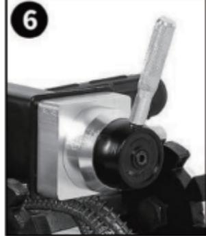
4. Beim Ausrichten der Arbeitsposition stellen Sie die Griffstange in die horizontale Richtung und justieren Sie die Position des Wagenhebers nach Bedarf.
